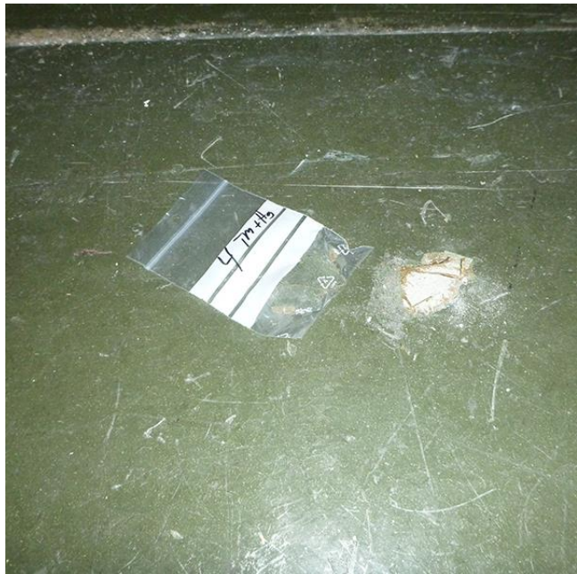
Rom 114: prøve 4. Linoleumsbelegget inneholder tungmetaller og klassifiseres som farlig avfall.
