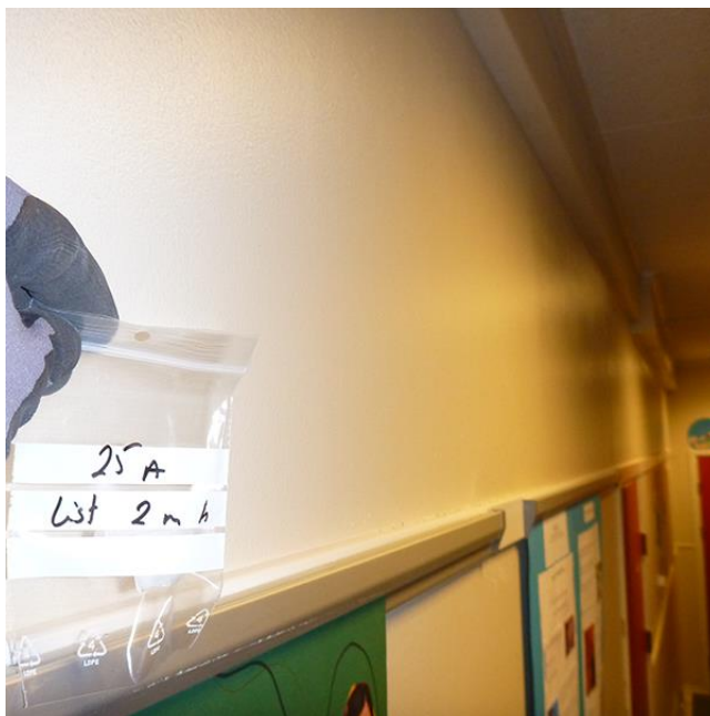
Korridor 113: prøve 25, støv på list inneholder ikke asbest
